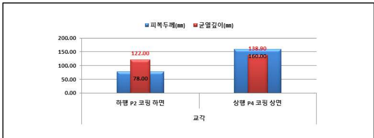
[그림 3.24] 균열깊이 측정 결과 그래프
